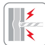
Механическое повреждение изоляции
